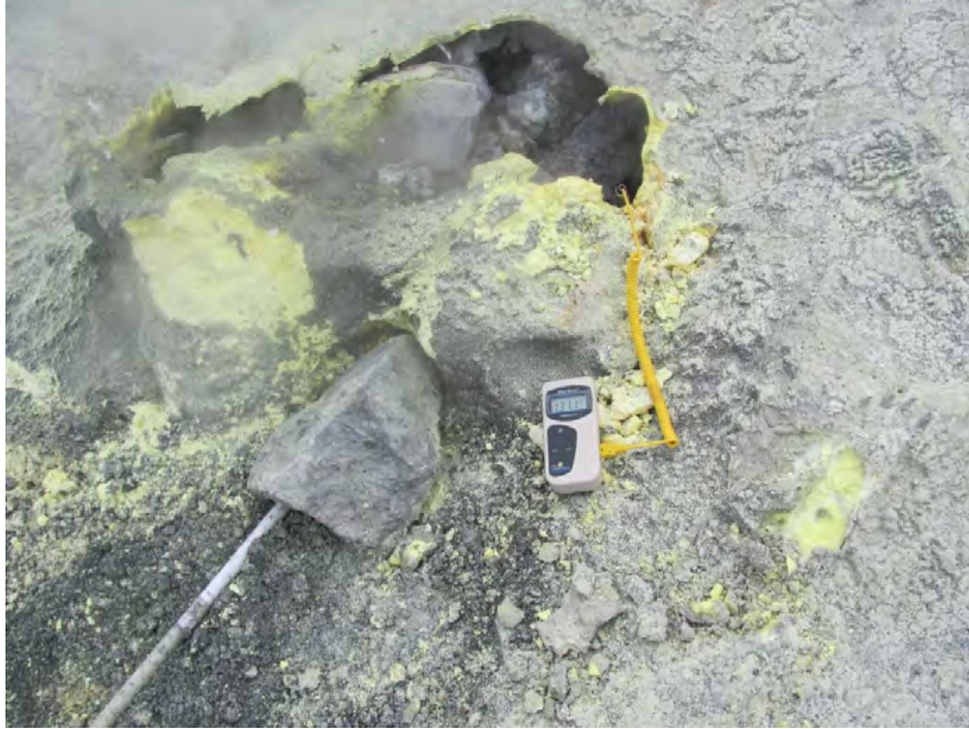
Figura 85: Detalle de la estación termométrica telemétrica instalada en el campo fumarólico lateral del volcán Puracé.
